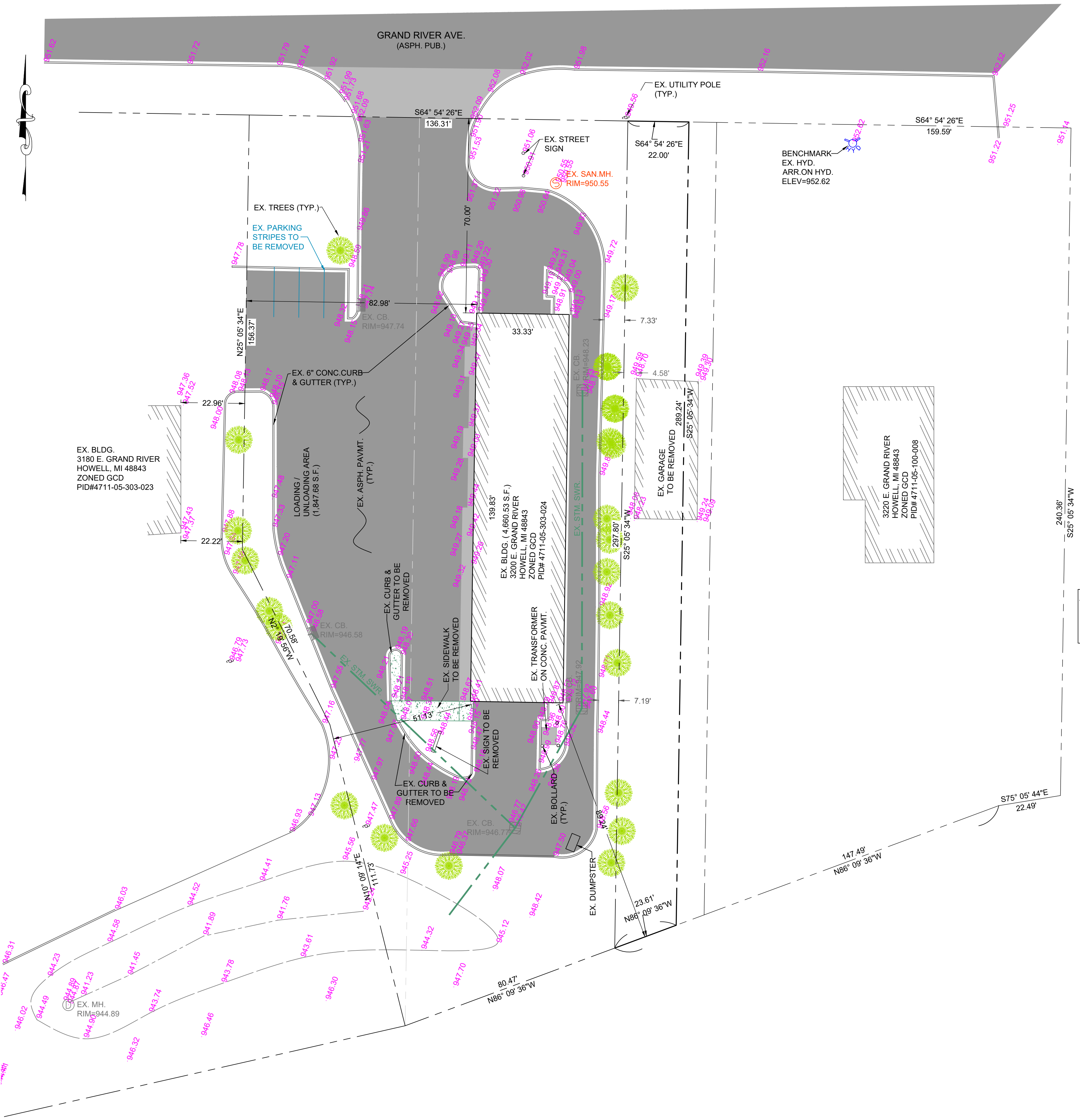
TOPOGRAPHIC SURVEY SCALE: 1" = 20.00'
